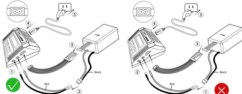
**WARNING** DO NOT POWER ON THE CHARGER AT THE WALL SOCKET
